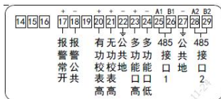
图2 电能表接线端子功能示意图
